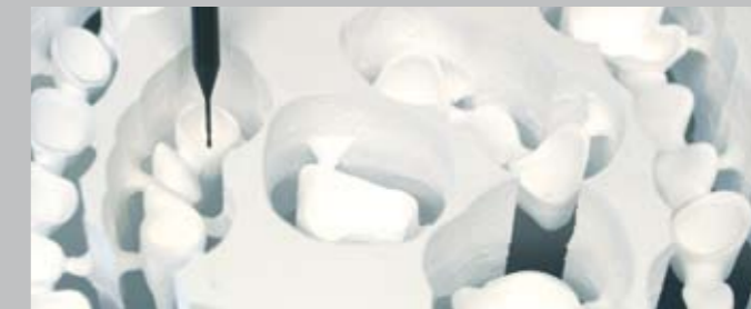
Detailansicht von der Bearbeitung der Unterseite eines Zirkonrohlings mit einem speziellen Dental-Radiusfräser.
