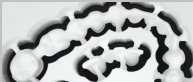
Detailansicht der Oberseite eines Zirkonrohlings – es können bis zu vierzehngliedrige Brücken gefräst werden.
